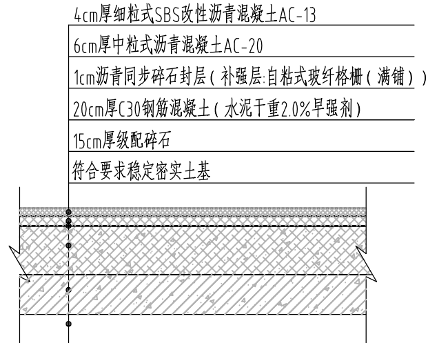
小区道路恢复结构图（沥青路面）
