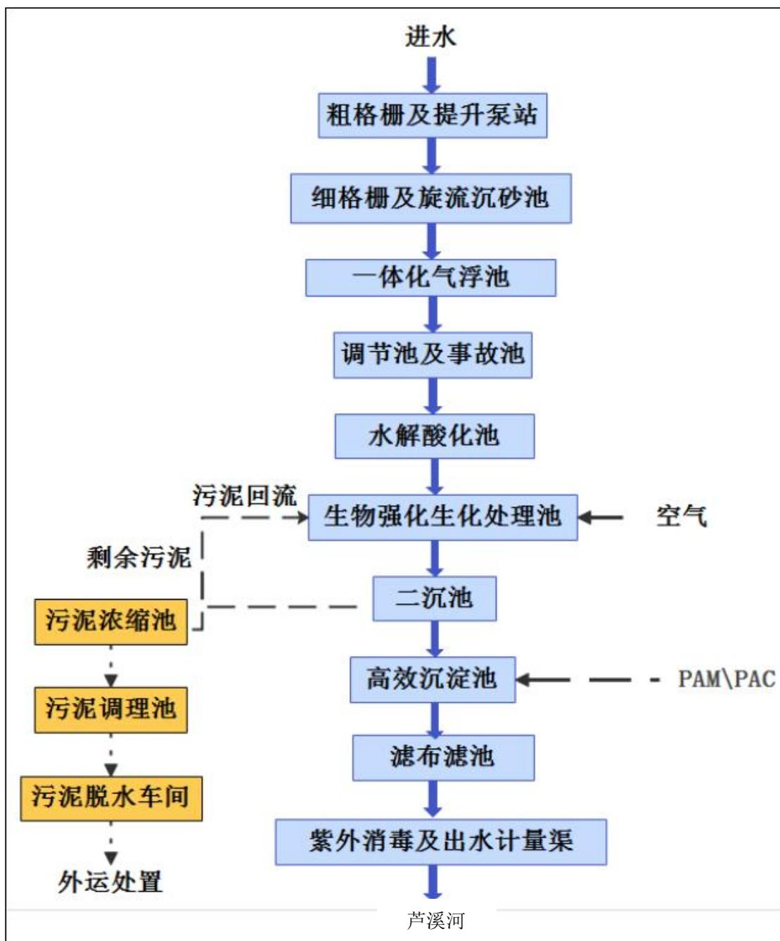
图 3.3.1-1 安定工业区污水处理厂工艺流程图
