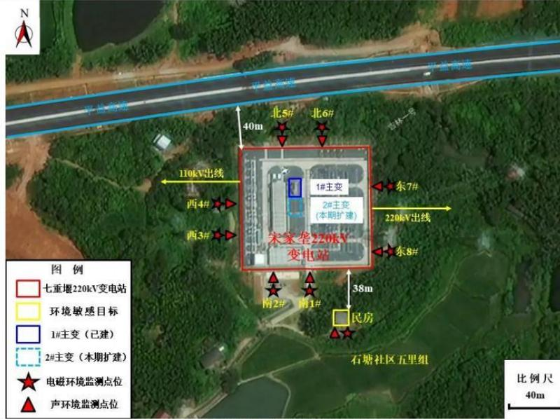
图1 宋家壩 220 千伏变电站检测点位示意图
