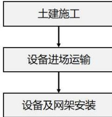
图 3 变电站间隔扩建工程施工工艺流程
