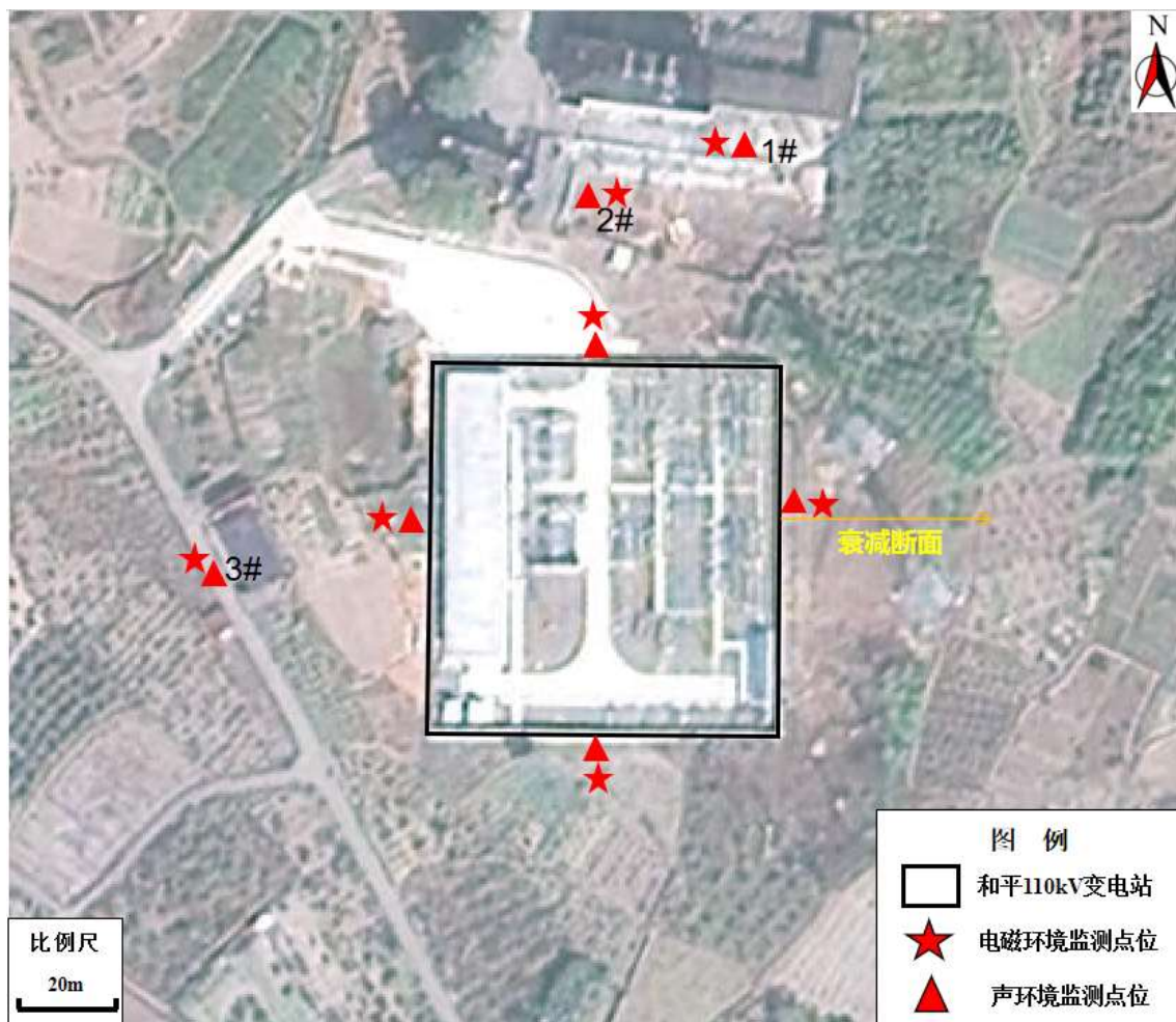
图 7 和平 110kV 变电站监测布点示意图
